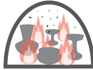
愛知県の猿投窯で、焼成中の窯内で須恵器に灰が付着して溶け、ガラス質になることを発見⇒焼成前の素地に水で溶いた灰を掛けて焼成するようになります。=「灰釉」の誕生
